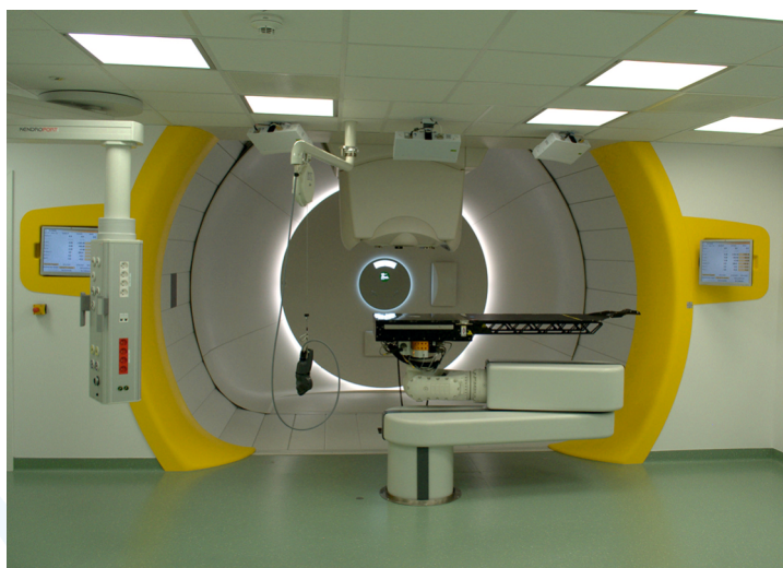
Stanowisko gantry z wiązką skanującą do radioterapii nowotworów zlokalizowanych w dowolnym miejscu ciała poza narządem wzroku
